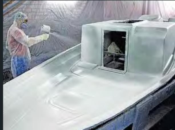
Gelcoat in mehrfach Schichten aufbringen
