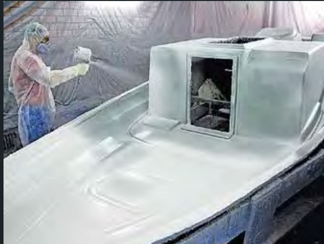
Gelcoat in mehrfach Schichten aufbringen
